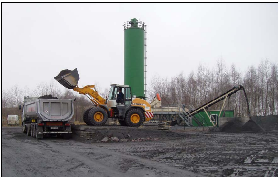
Foto 4 – Výroba popílkových stabilizátů na odkališti KIII, který je používán jako základní rekultivační materiál.
