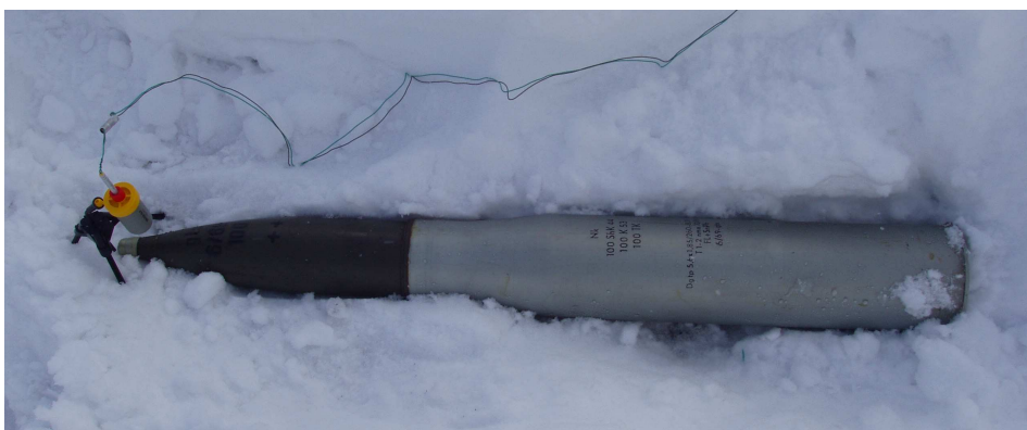
Obr. 7 – detail odděleného zapalovače
