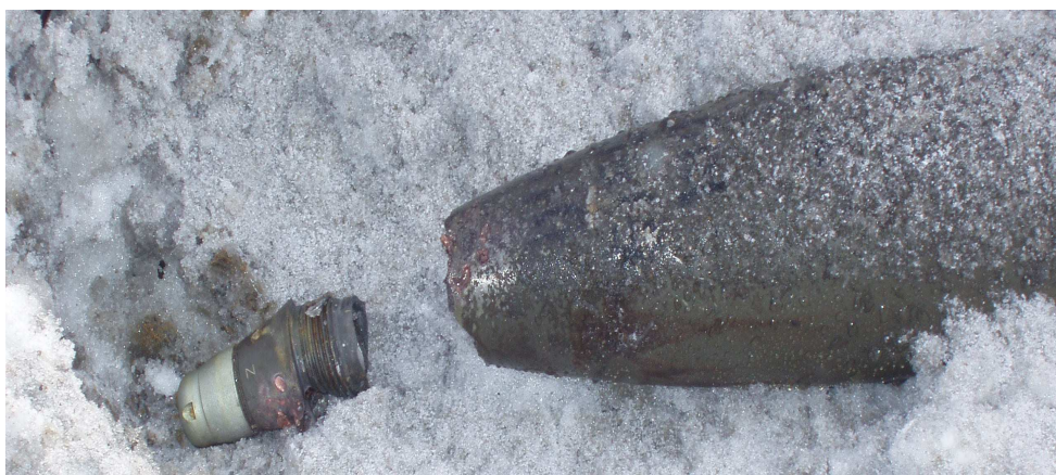
Obr. 7 – detail odděleného zapalovače
