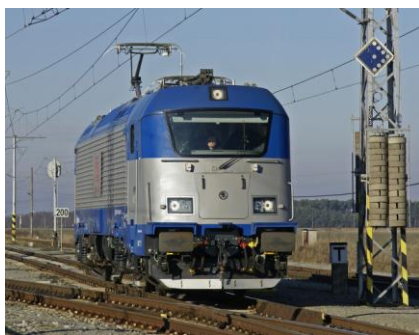
Obr.: Nová třísystémová lokomotiva Škoda 109E. Do budoucna se počítá s vybavením lokomotivy jednotným evropským zabezpečovacím systémem ETCS. © Wikipede, otevřená encyklopedie
