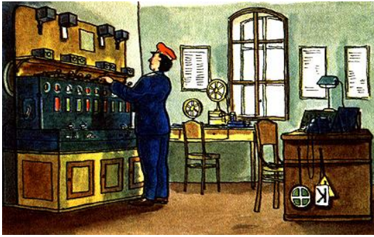
Obr.: Ve starších dopravních kancelářích je možné ještě vidět řídicí přístroj elektromechanického staničního zabezpečovacího zařízení, který zabraňuje bez vědomí výpravčího přestavění jízdní cesty vlaku a kontroluje práci signalistů na stavědle. (ilustrace Jiří Bouda)
