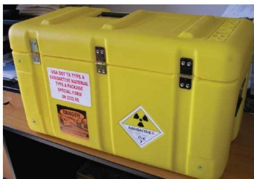
Obr. 11. Bezpečnostní značka se symbolem zářiče 30
