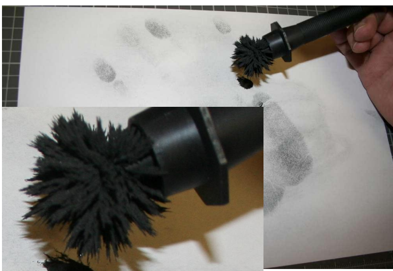
Vyvolání stopy za pomoci prášku ferropodium a magnetického štětce – fyzikální metoda
