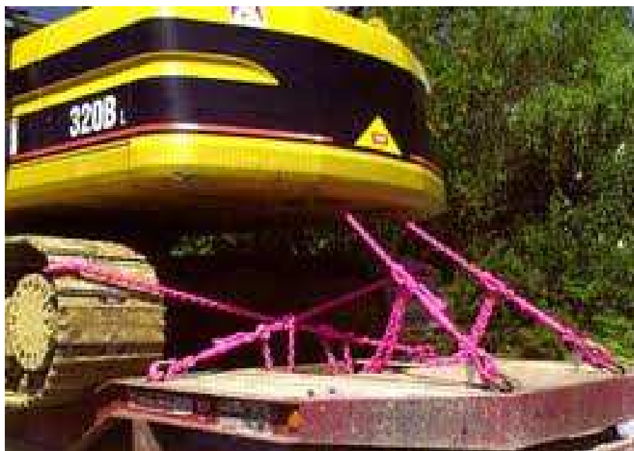
Obr. 2: příklad upevnění nákladu - řetězy
