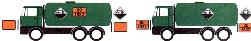
Způsob označení cisternového vozidla při přepravě jednoho druhu látky
