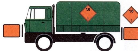
Způsob označení vozidla při přepravě výbušných látek nebo předmětů třídy 1
