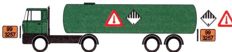
Způsob označení cisternového vozidla při přepravě zahřáté látky
