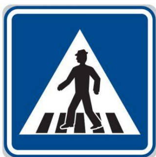
Obr. 7 - Přechod pro chodce
