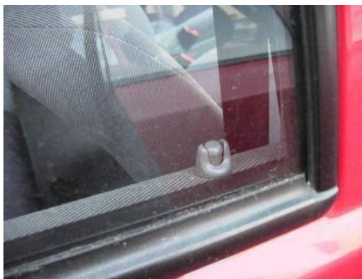
Obrázek č. 5. Kryt zajišťovacího kolíku 29
