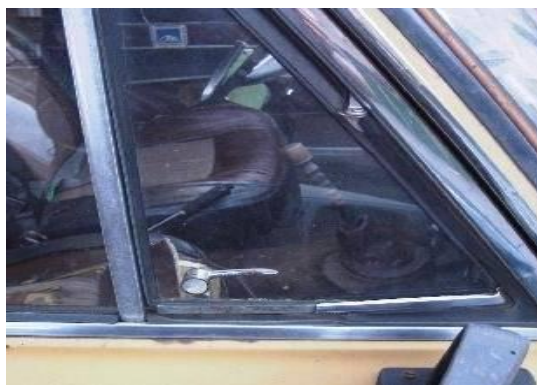
Obrázek č. 3. Umístění kliky větracího okénka 26
