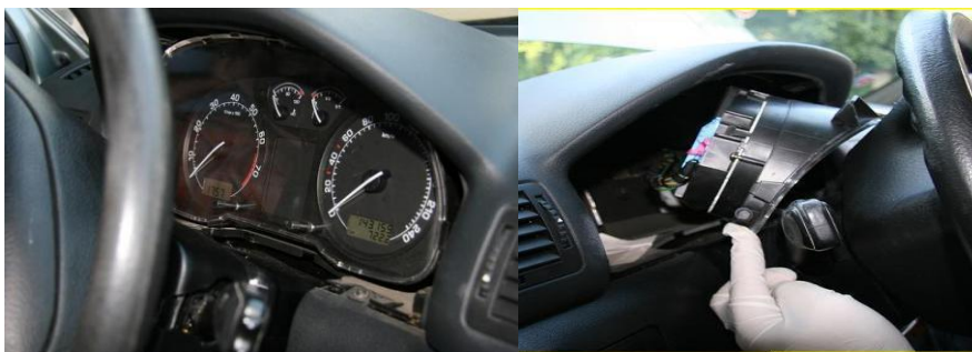
Obrázek 5: Palubní deska Škody Octavia a její výměna 22
