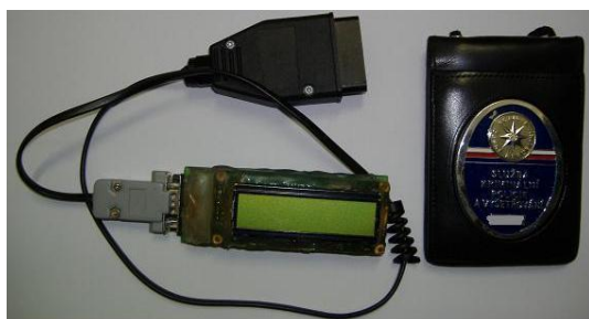
Obrázek 8: Zařízení umožňující překonání imobilizéru vozidel VW 29 .
