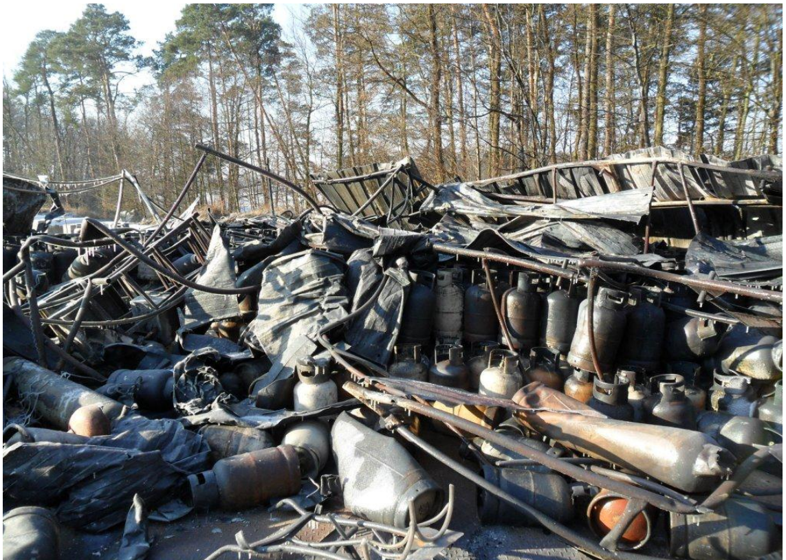
Uskladněné plynové lahve poničené vlivem požáru
