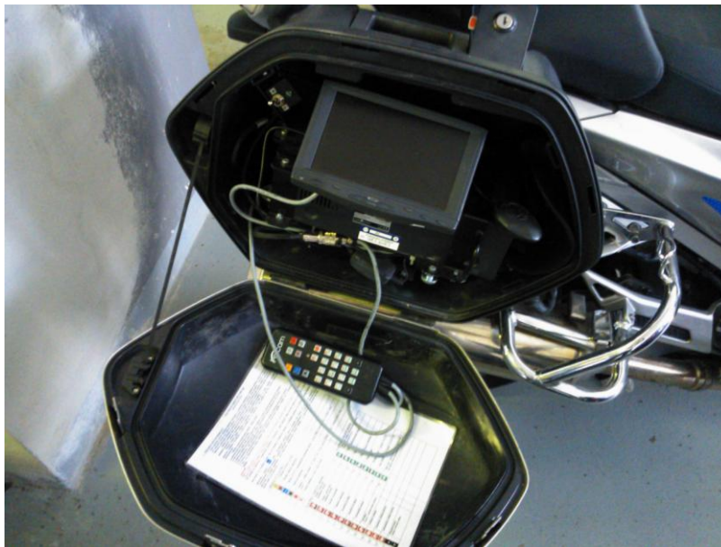
Obr. č. 11: Měřič rychlosti PolCam zabudovaný v motocyklu Yamaha FJR1300A 64
