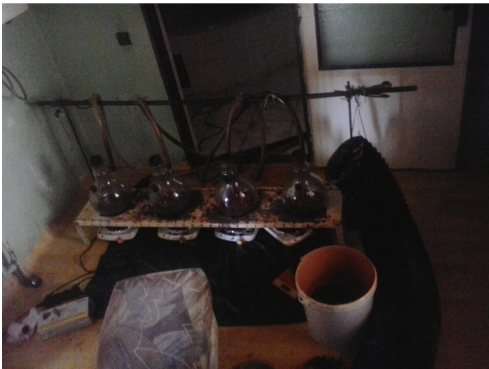
Trojcestné baňky se směsí matečáku, fosforu a její zahřívání.
