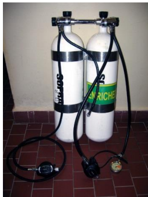
Obr. 3 Tlakové láhve s plicními automatikami 34
