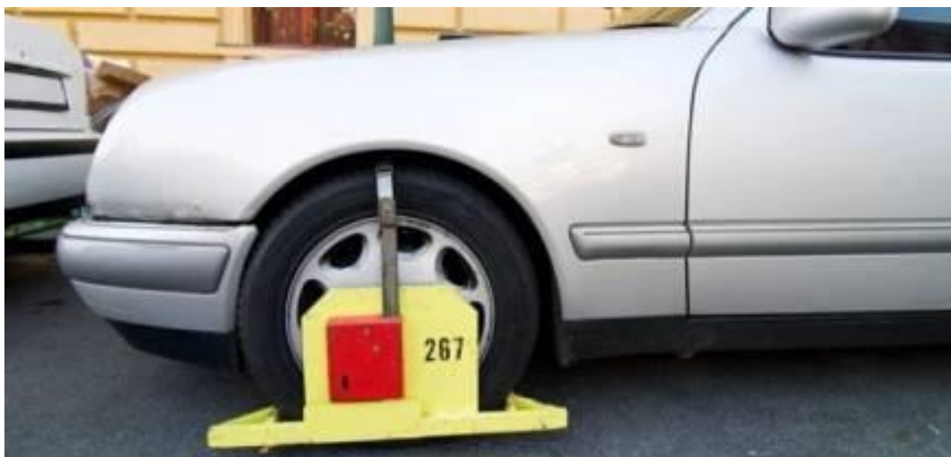
Obr. 7: Prostředek k zabránění odjezdu vozidla „Botička“ 25
