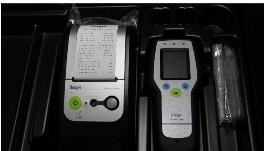
Obr. 1: Souprava nejpoužívanějšího přístroje Dräger 7510 s tiskárnou a náustky 19
