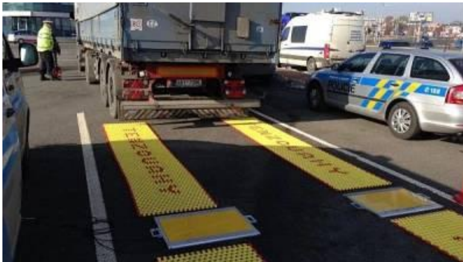
Obr. 6: Použití nízkorychlostní váhy 24
