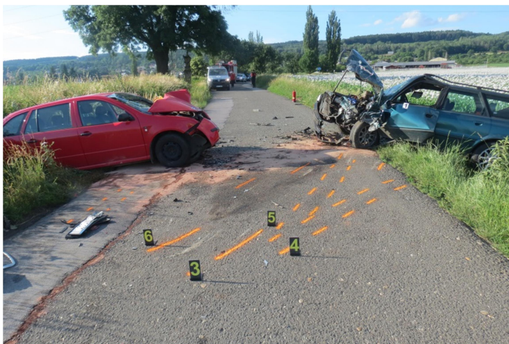
Obr 6: polodetailní fotografie zaměřená na část zúčastněných vozidel a na vyhledané stopy, fotografie podává také ucelený obraz o stopách od pneumatik vozidla vpravo. Celkový pohled na takto vzniklé stopy vypovídá o místě střetu vozidel. 35
