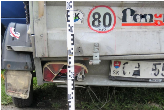
Obr 7: Detailní fotografie, snímek slouží k přesnému zadokumentování poškození, zpravidla se k těmto detailním fotografiím přikládá měřítko. Fotografie dává přesný přehled o výšce a velikosti poškození. 36
