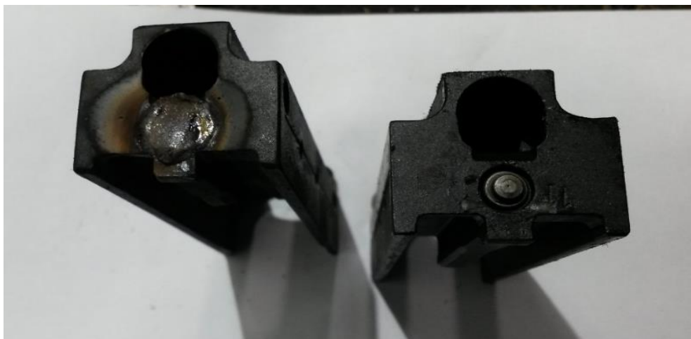
„Obr. 16: Zápalcík zavařený a před zavařením“ 61
