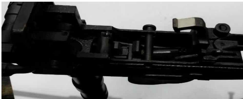
„Obr. 17: Bicí mechanismus před svárem“ 62
