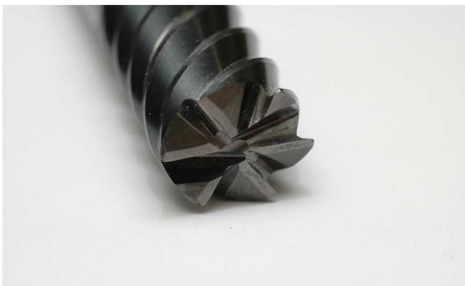
„Obr. 3: Detail čela frézy s břitem se slinutého karbidu“ 48
