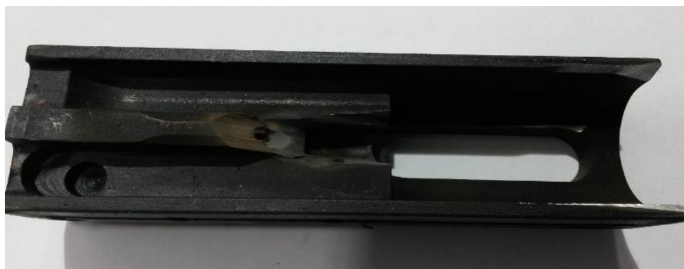
„Obr. 15: Závěr samopalů po ubroušení“ 60
