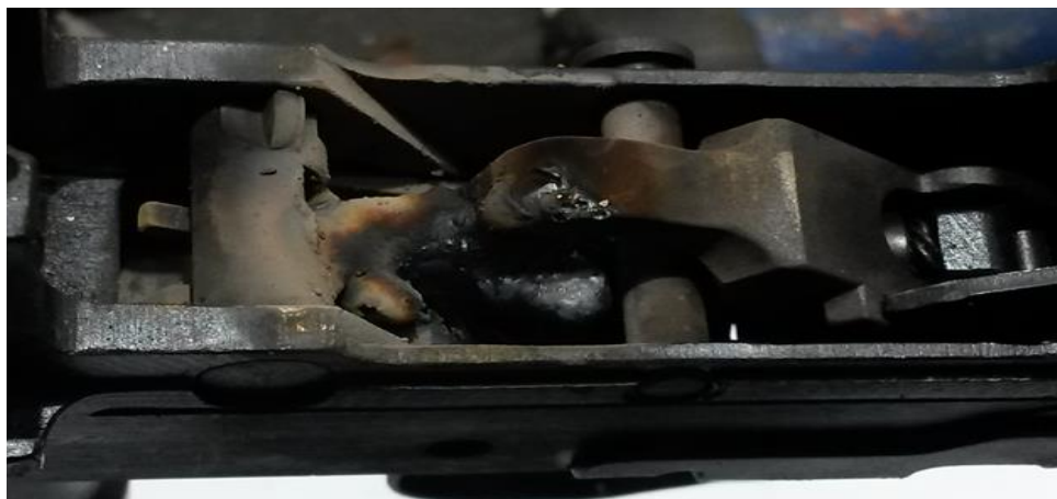
„Obr. 18: Svár na bicím mechanismu“ 63
