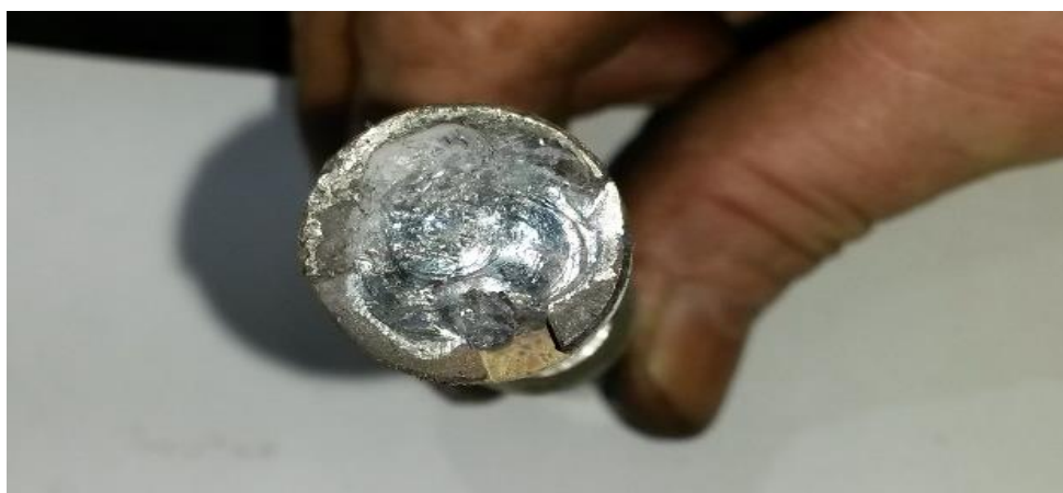
„Obr. 13: Kolík pevně spojený svárem k hlavni“ 58
