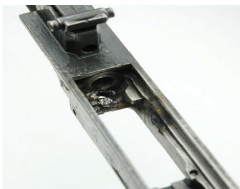
„Obr. 9: Řezání elektrodou OK 21.03“ 54
