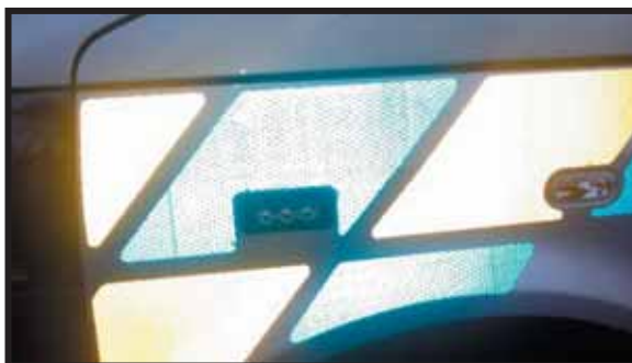
Obrázek č. 44: Volkswagen T5 Transporter, výstražné světlo do boku v předním blatníku. 58
