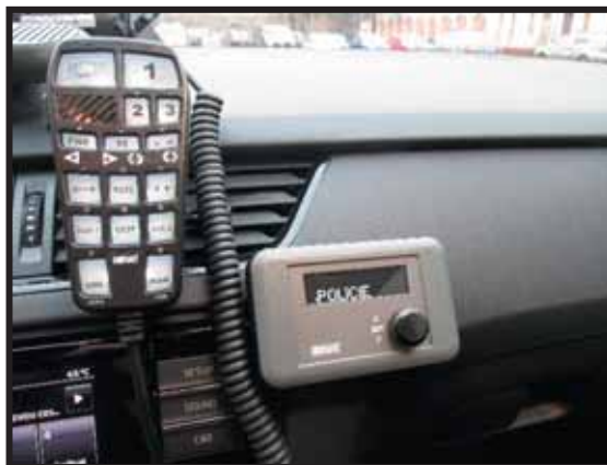
Obrázek č. 47: Ovládací panel k ZVZ řady AZD 400. 61
