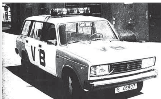
Obrázek č. P160 a P161: Prototypy majáků Tesla AZD 530 na vozech SNB (Tatra 613 ÚRN a VAZ 2104 VB).
