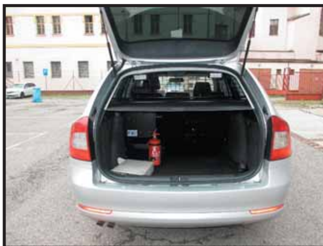
Obrázek č. 62: Bezpečnostní přepážka mezi zavazadlovým prostorem a prostorem pro osádku - mříž. 76
