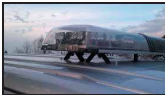
Obrázky č. 31 a 32: Volkswagen Transporter s modernizovaným majákem řady VxL v LED provedení. 48
