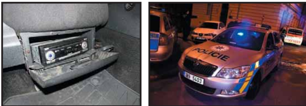
Obrázky č. 69 a 70: Škoda Octavia II Combi - Beruška. Vlevo autorádio pod sedadlem spolujezdce vpředu 84 a vpravo modré světlo Whelen® Talon za čelním sklem. 85
