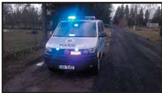
Obrázky č. 31 a 32: Volkswagen Transporter s modernizovaným majákem řady VxL v LED provedení. 48
