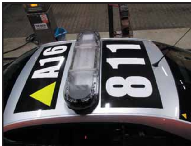
Obrázek č. 78: Škoda Octavia III, PMJ Praha. Jedna z testovaných variant nápisu na střeše vozidla. 90
