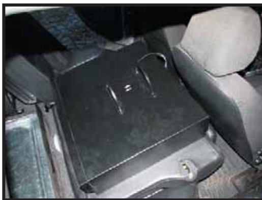
Obrázky č. 73 a 74: Škoda Octavia II Combi - Beruška. Prototyp bezpečnostní schránky na stěně zadního sedadla. 87
