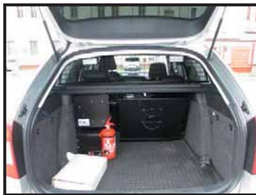
Obrázky č. 73 a 74: Škoda Octavia II Combi - Beruška. Prototyp bezpečnostní schránky na stěně zadního sedadla. 87
