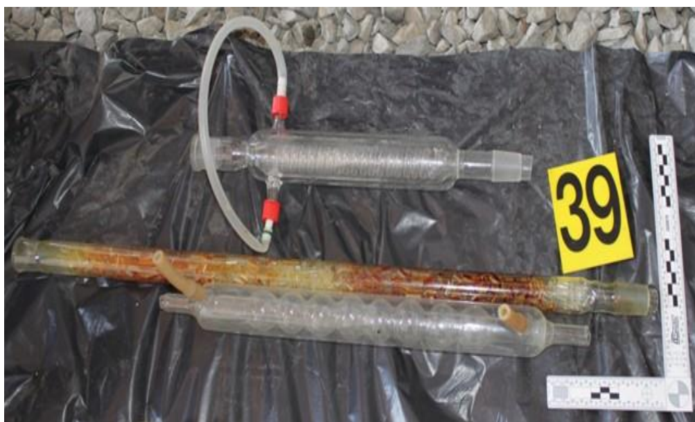
Chladiče pro zachycení výparů při výrobě pervitinu a kondenzaci par
