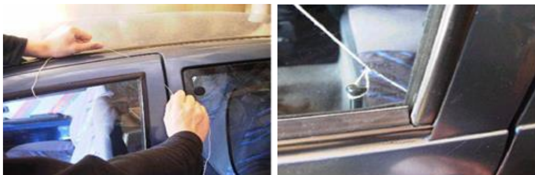
Obrázek č. 4 a 5 - Využití provázku k vytažení zajišťovacího kolíku dveří vozidla.
