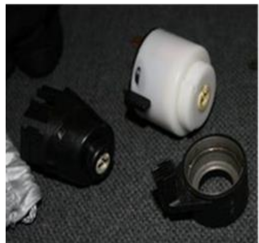
Obrázek č. 21 - Spínačka a transpondér.
