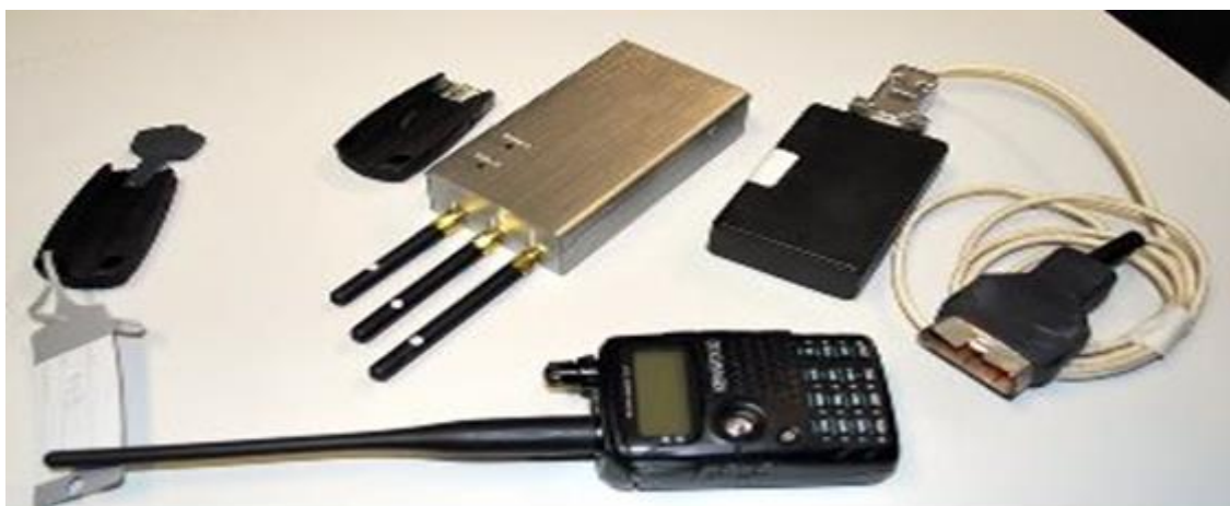
Obrázek č. 17 – kompletní souprava elektronického překonání systému pro odcizení vozidla a vyřazení signálů jeho zabezpečení.
