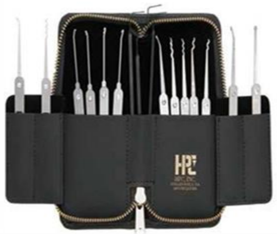
Obrázek č. 16 - Profesionální sada planžet pro manipulaci se stavítky vložek auto-zámků.
