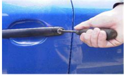
Obrázek č. 2 - Zaražení šroubováku do zámku dveří
