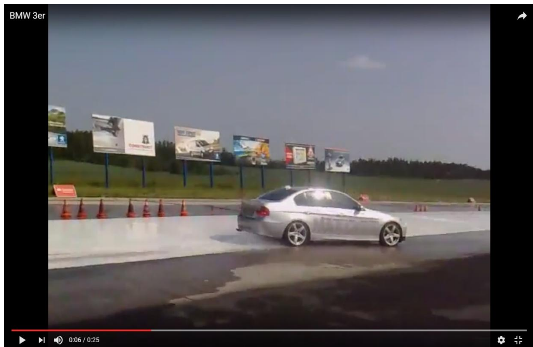
Obr. 10: Vůz brzdící levými koly na kluzkém povrchu v přetáčivém smyku 35
