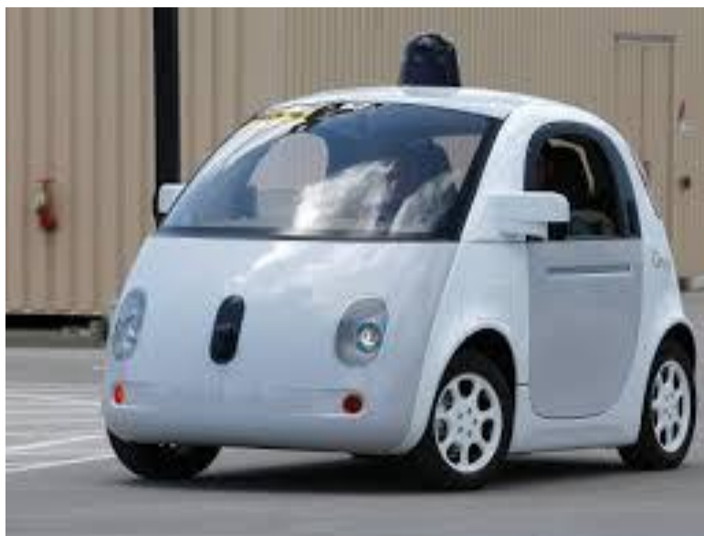
Obr. 8: Autonomní vozidlo společnosti Google. „Klobouk“ na střeše obsahuje rotační čidlo pro sledování situace kolem vozidla, s úhlem záběru 360 o . 33
