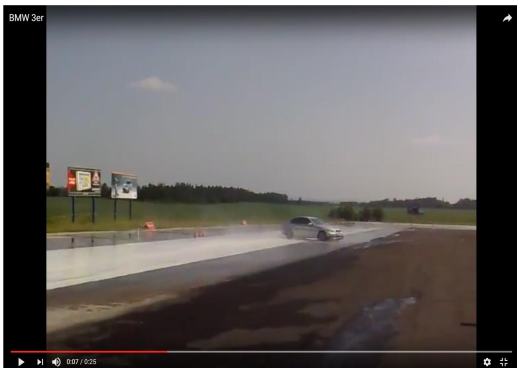
Obr. 10: Vůz brzdící levými koly na kluzkém povrchu v přetáčivém smyku 35
