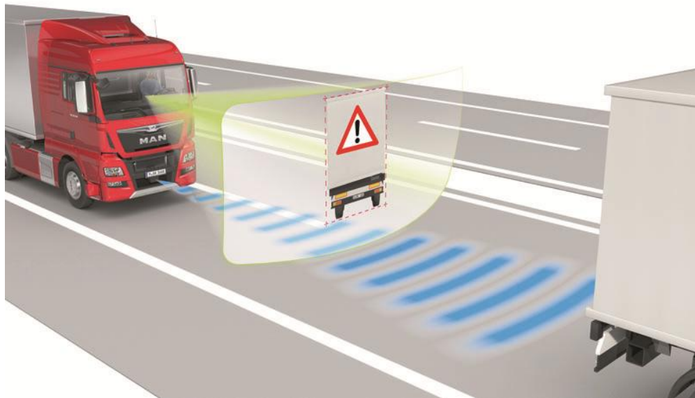
Obr. 7: Systém EBA pracuje s radarovou technologií a s kamerou 29
