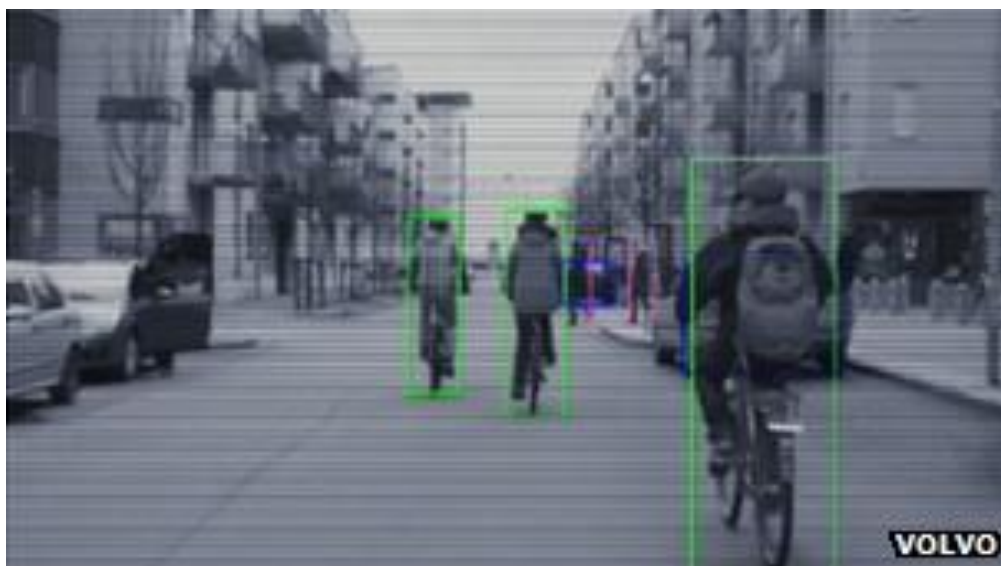
Obr. 4: Systém detekuje pohybující se objekty před vozidlem (chodci, cyklisté) 19
