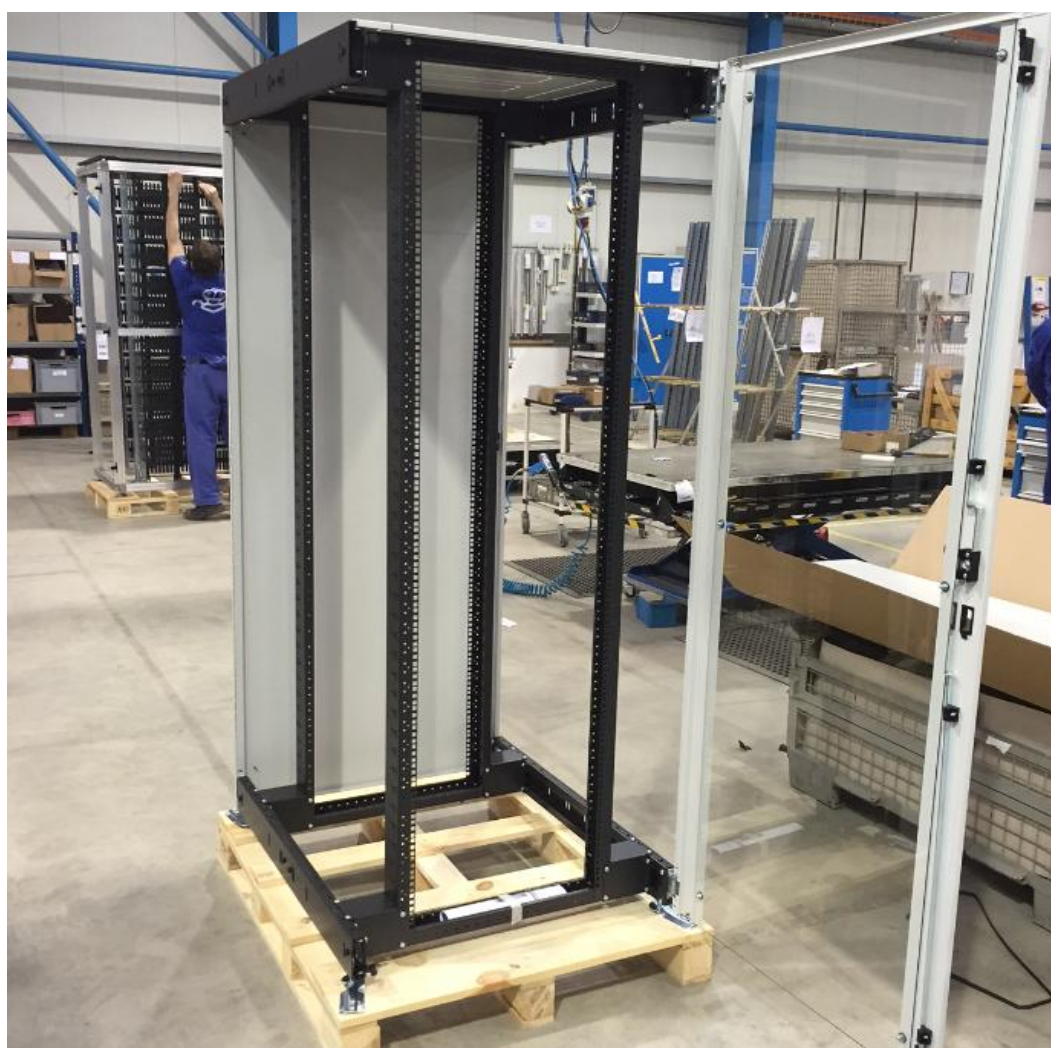
Obrázek č. 6: Ukázka téměř smontované skříně INSTA Rack 28
