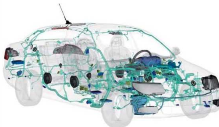
Obrázek č. 4 Rozmístění kabelových svazků ve vozidle Škoda Superb II 9
