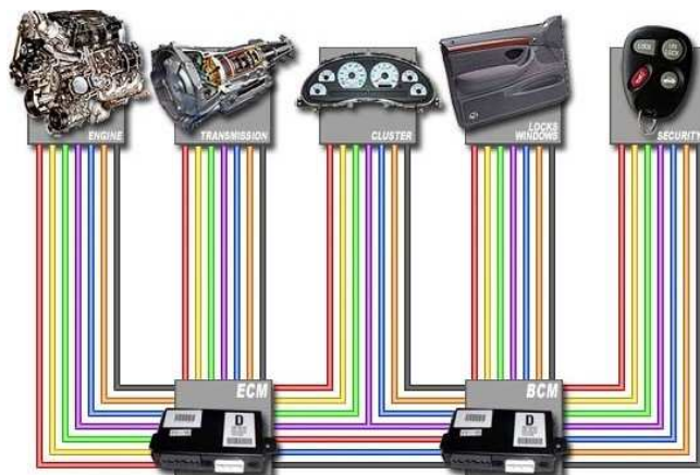
Obrázek č. 6 Propojení elektronických systémů pomocí datové sběrnice CANBUS. 15
