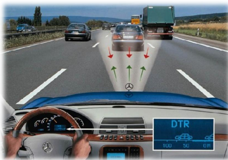
Obrázek 17 - Elektronický systém Adaptive Cruise Control 39
