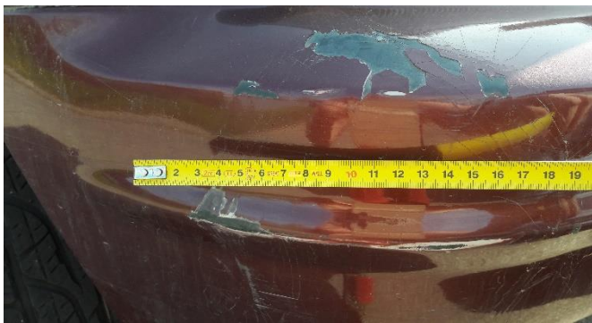
Foto č. 9 pohled na poškození předního nárazníku
