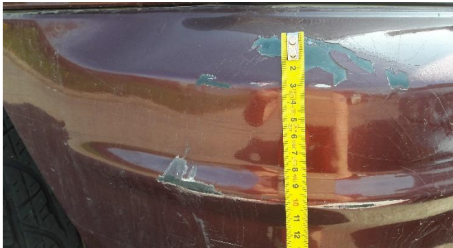
Foto č. 8 pohled na poškození předního nárazníku
