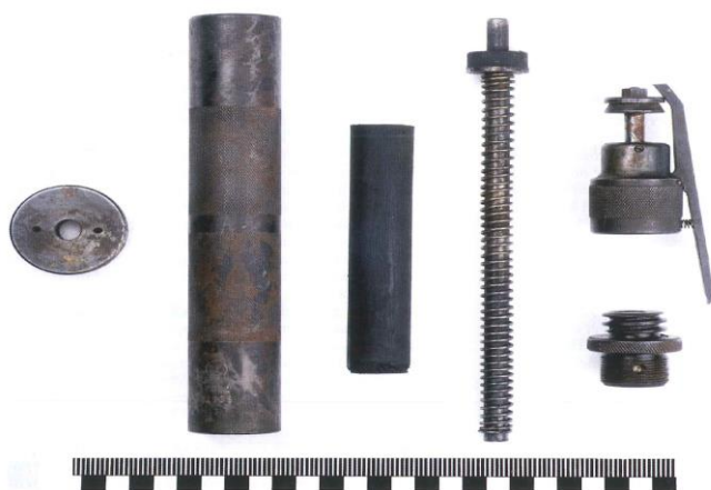
Obr. 4 Jateční přístroj Zbrojovka Brno model 25, rozebraný
