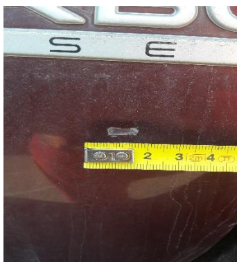
Foto č. 6 pohled na poškození zadního nárazníku
