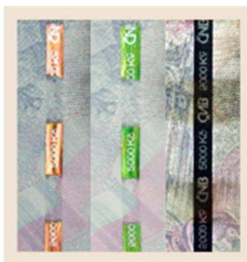
Obrázek č. 3: Okénkový proužek s mikrotextem - průhled z líce Zdroj: ČNB 14
