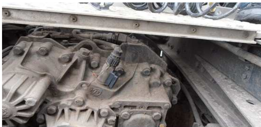
Obrázek č. 16 - Umístění magnetu na čidlo převodovky
