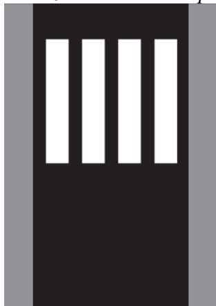
Obrázek 1 – Přechod pro chodce, vodorovná dopravní značka V 7a 39
