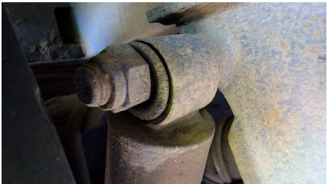
Fotografie č. 4 – Závada uchycení tlumiče 33
