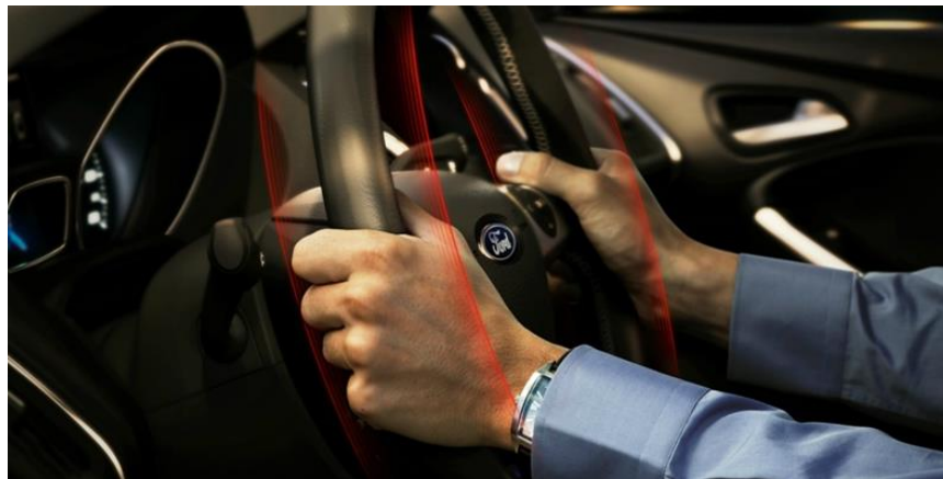
Obr. 5: Varování systému LDW za pomoci vibrací do volantu. Zdroj: http://www.autolexicon.net/cs/articles/ldw-lane-departure-warning/
