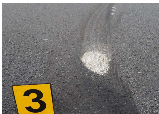
Obr.10: Rýhy od podvozku osobního vozidla 57
