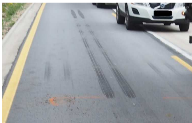
Obr. 11: Stopy brzdění vozidla vybaveného ABS 59
