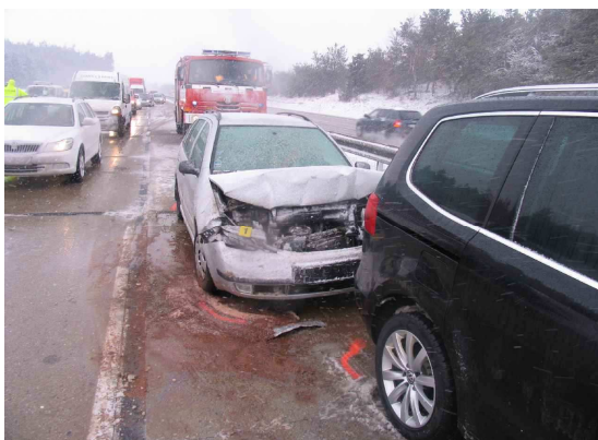
Obr. 13: Pohled na stopy chladicí kapaliny 63
