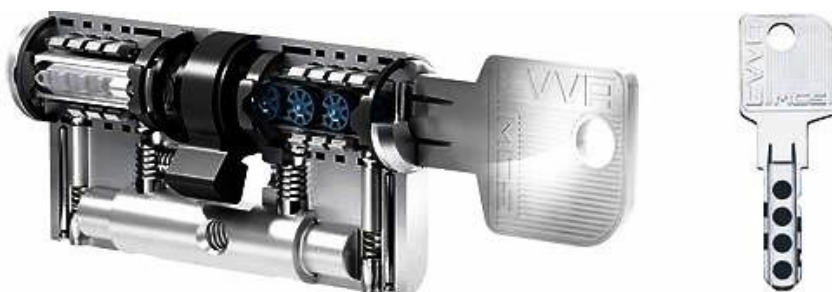
Obr. 49: Cylindrická vložka MCS s magnetickým kódováním 143
