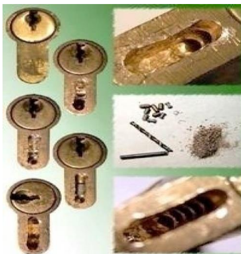
Obr. 38: Odvrtání stavítkového kanálu 120
