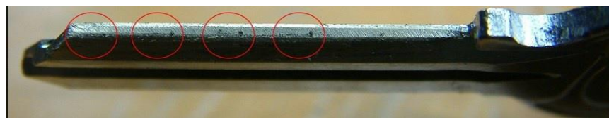
Obr. 45: Rýhy vytvořené na polotovaru klíče metodou impressioning 135
