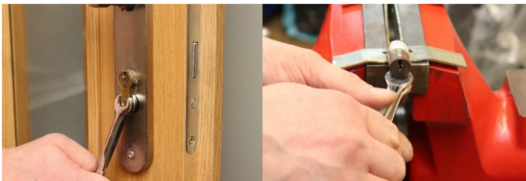
Obr. č. 52, 53, Experiment o rozlomení cylindrické vložky a nasazení nástroje, vytvoření stopy Zdroj: vlastní
