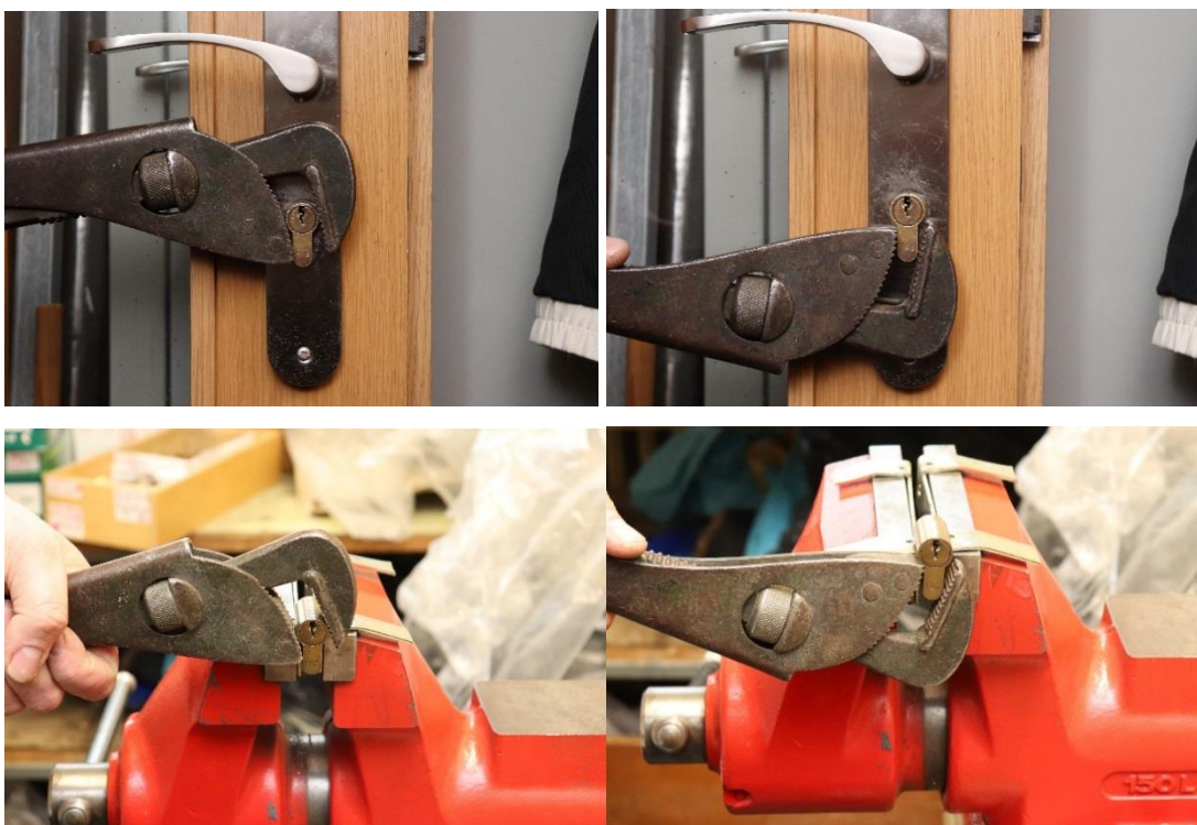
Obr. č. 35, 36, 37, 38, Experiment o rozlomení cylindrické vložky a nasazení nástroje, vytvoření stopy Zdroj: vlastní
