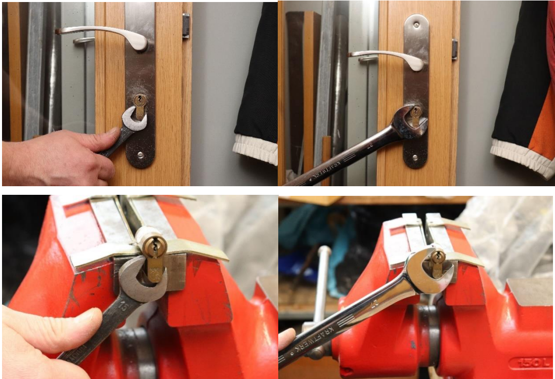
Obr. č. 57, 58, 59, 60, Experiment o rozlomení cylindrické vložky a nasazení nástroje, vytvoření stopy Zdroj: vlastní
