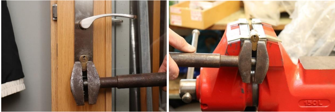
Obr. č. 43, 44, Experiment o rozlomení cylindrické vložky a nasazení nástroje, vytvoření stopy Zdroj: vlastní
