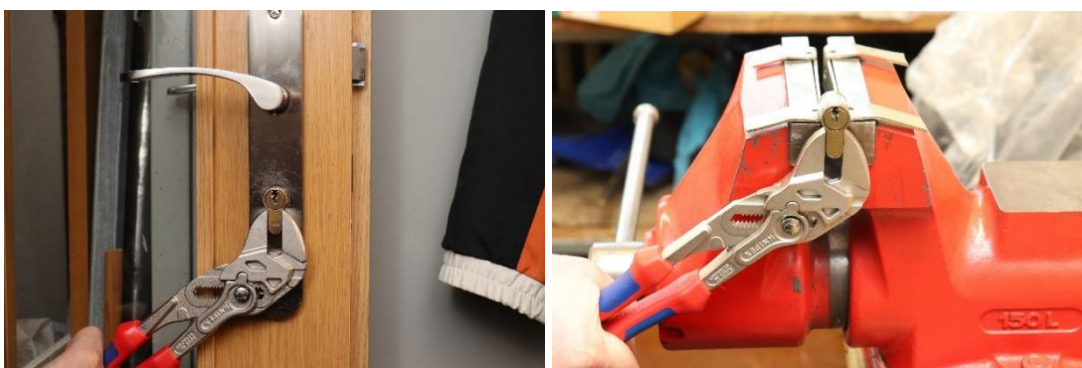
Obr. č. 30, 31, Experiment o rozlomení cylindrické vložky a nasazení nástroje, vytvoření stopy Zdroj: vlastní
