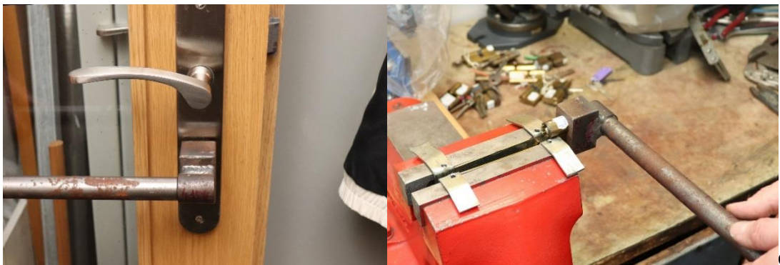
č. 69, 70, Experiment o rozlomení cylindrické vložky a nasazení nástroje, vytvoření stopy Zdroj: vlastní
