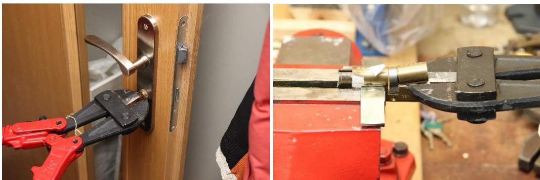
Obr. č. 47, 48, Experiment o rozlomení cylindrické vložky a nasazení nástroje, vytvoření stopy svorníkovými kleštěmi, Zdroj: vlastní
