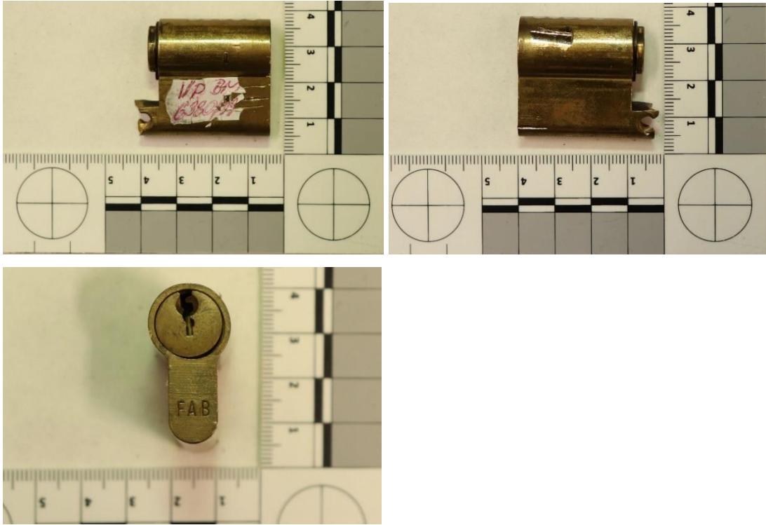
Obr. č. 39, 40, 41, Detailní pohled na zanechané stopy, levá a pravá strana, Zdroj: vlastní
