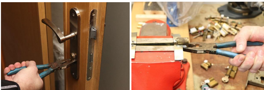
Obr. č. 19, 20, Experiment o rozlomení cylindrické vložky a nasazení nástroje, vytvoření stopy Zdroj: vlastní
