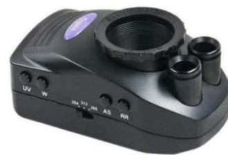
Obrázek 1: Lupa REGULA-přenosný ověřovací přístroj na kontrolu ochranných prvků
