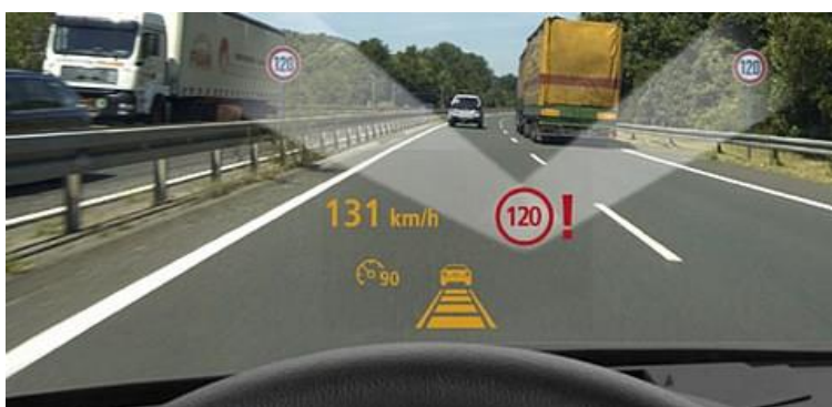
Obr. 3 - systém rozpoznávající dopravní značky promítaný na HUD 14
