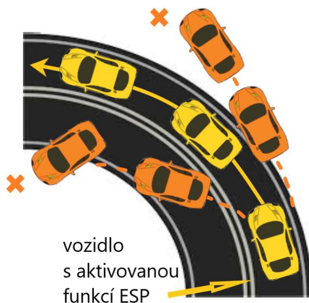
obr. 7 - chování vozidla se systémem elektronické stabilizace jízdy a bez 26
