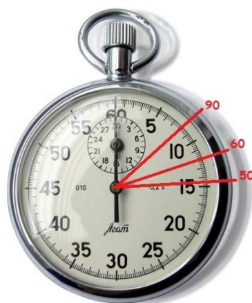
Obr. č.2: Stopky upravené pro měření rychlosti 9
