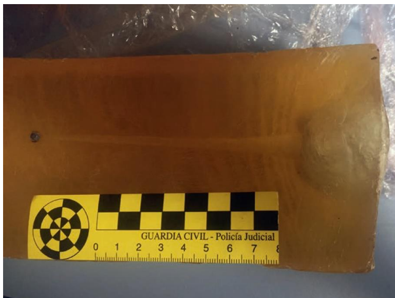
Obr. č. 2: Balistický blok po střele z upravené nábojky 8 mm PAK 87
