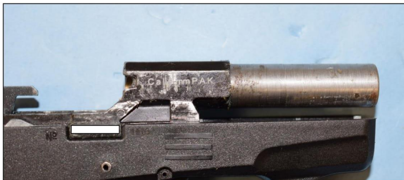
Foto č. 2 – detail osazení zbraně novou hlavní
