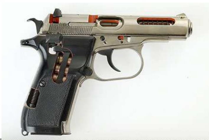
Obr. č. 5: Řez zbraně ČZ model 83 104
