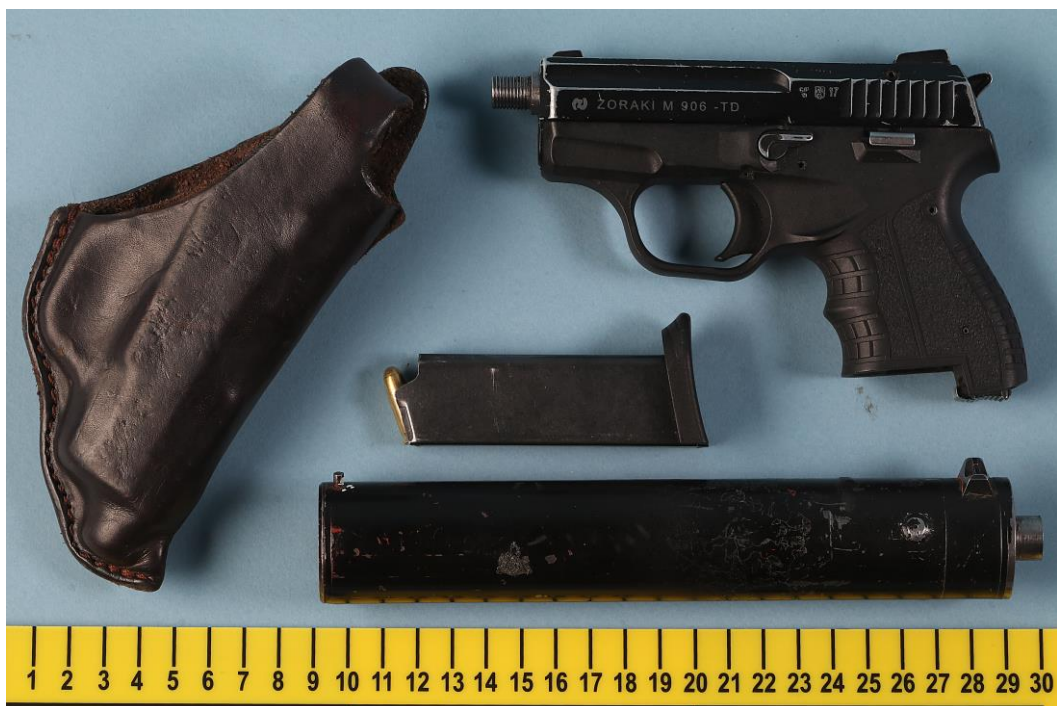
Obr. č. 6: Upravená expanzní zbraň Zoraki M-906 111
