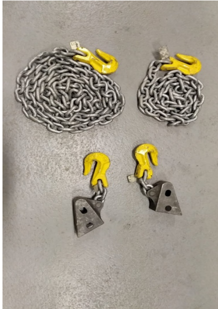
Obr. 15 Příslušenství k hydraulickému rozpínači – řetězy a háky 58
