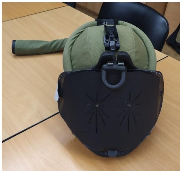
Obrázek 7 Ochranná EOD helma od firmy MED-ENG k obleku EOD 7b s přídavným ochranným štítem proti střepinám, zdroj: foto vlastní
