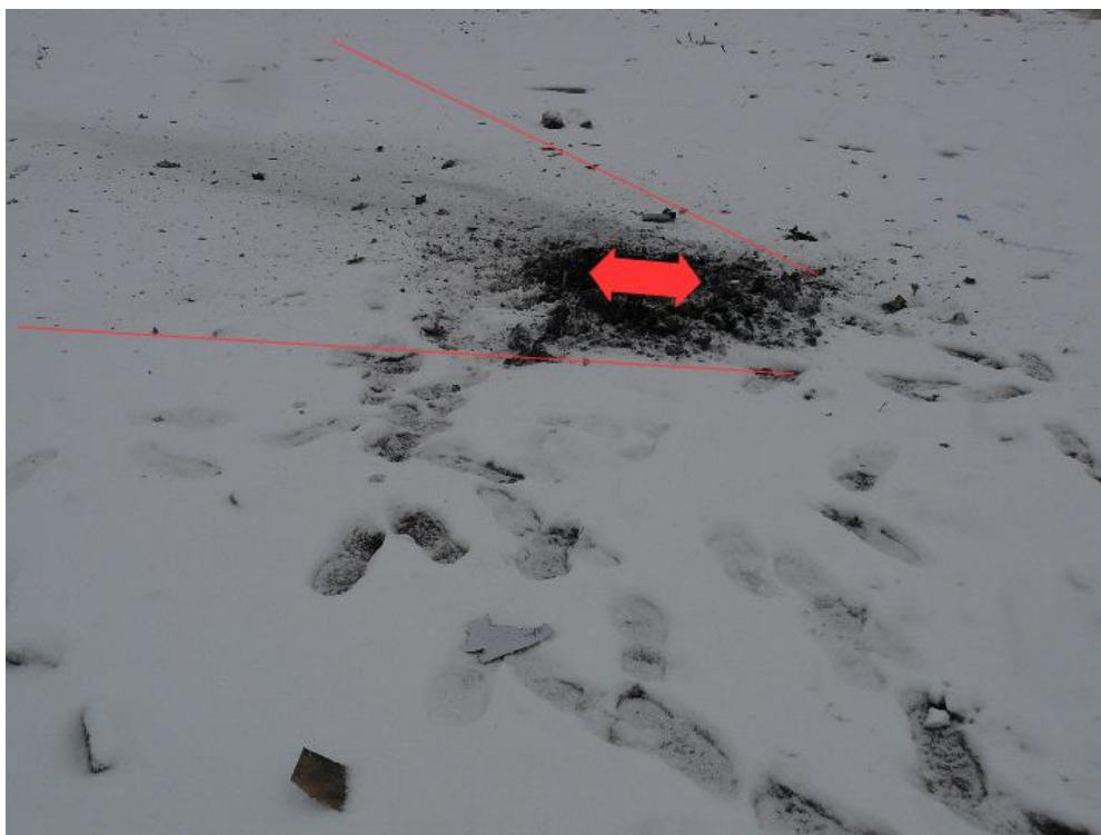
Obrázek 15 Místo iniciace vzorku č. 1 se zakresleným rozletem zbytků obalu a povýbuchových zplodin, zdroj: foto vlastní
