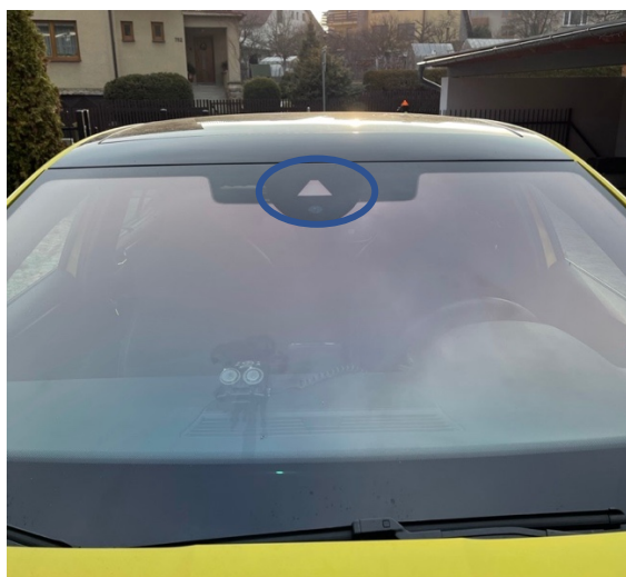
Obrázek 28 - Kamera pro rozpoznávání dopravních značek
