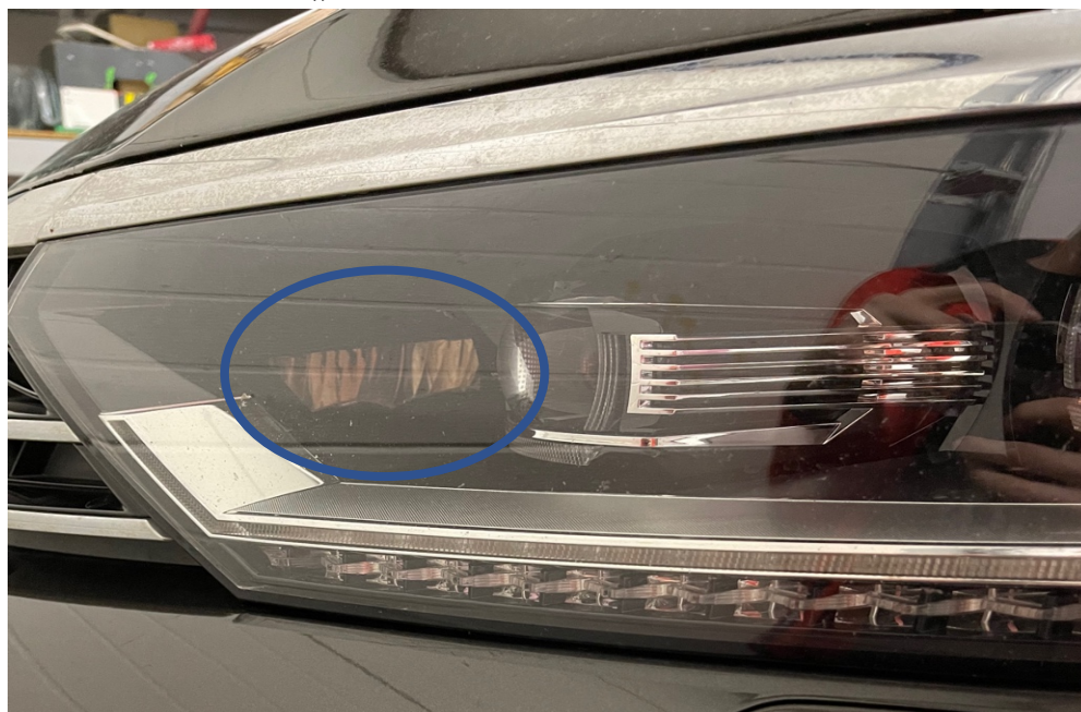
Obrázek 26 - Funkce „Corner“ v hlavním světlometu
