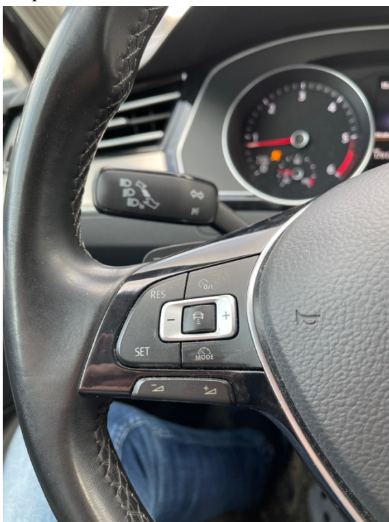
Obrázek 27 - Ovládací centrum adaptivního tempomatu
