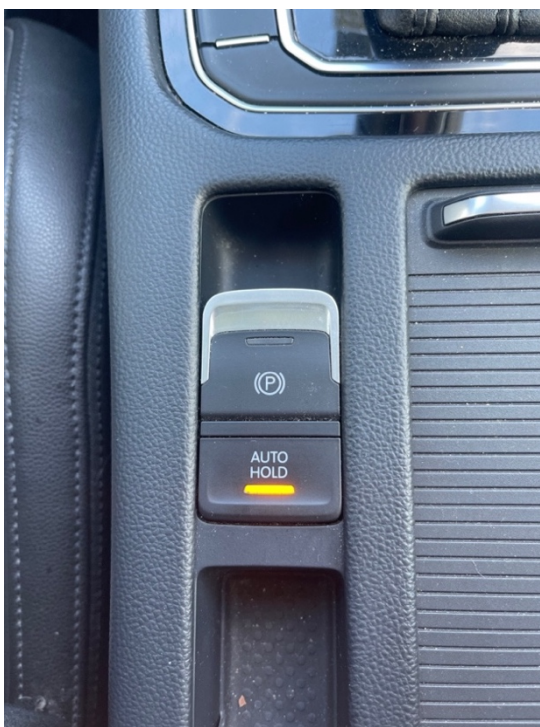
Obrázek 23 - Tlačítko Auto Hold + elektromechanická brzda
