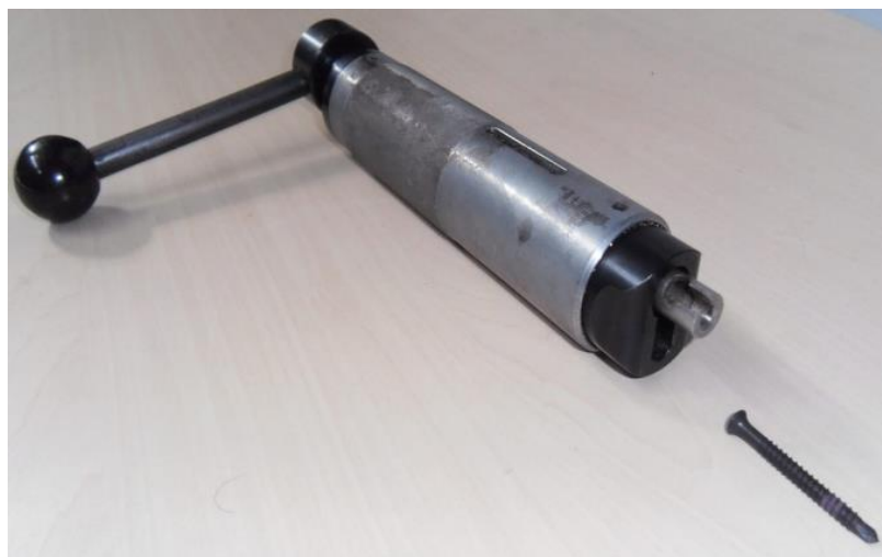
Obr. 8 - Speciální nástroj (tzv. "trhák") pro uchopení šroubu, který je v cylindru. Foto: KOBRČ Jiří
