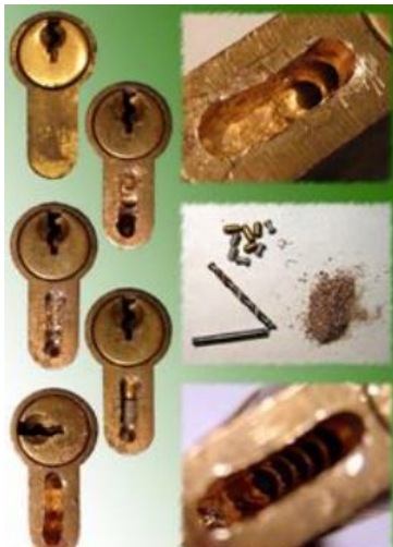
Obr. 7 - Odvrtání stavítkového kanálku. Foto: GAJDUŠKOVÁ Marcela
