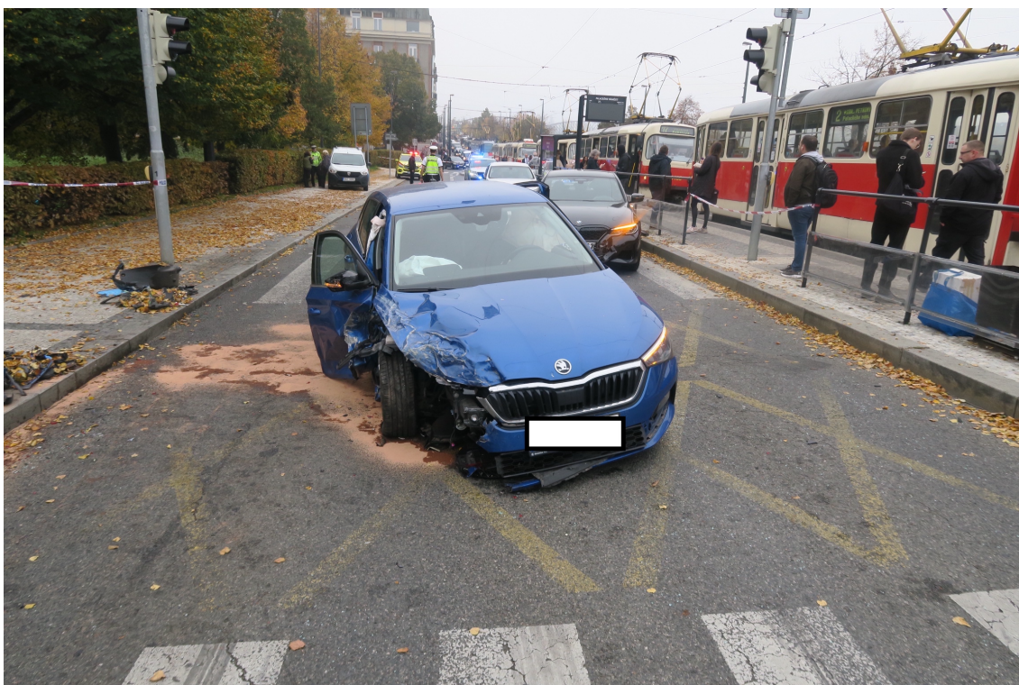
Obrázek 5 - Pohled na poškozené vozidlo ŠKODA SCALA a zasypané vyteklé provozní kapaliny, zdroj: vlastní
