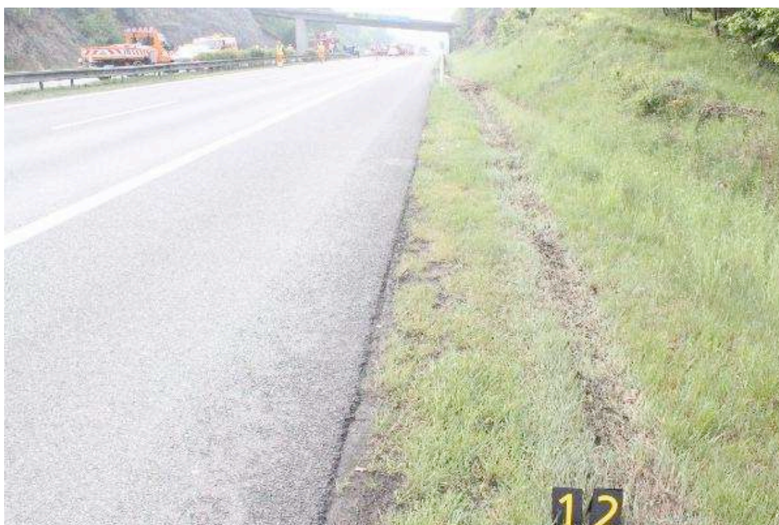
Obrázek 14 Pohled na rycí stopu pneumatik v nezpevněné pravé krajnici, zdroj: vlastní
