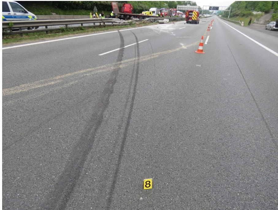
7 Pohled na brzdou dráhu nákladního vozidla, zdroj: vlastní
