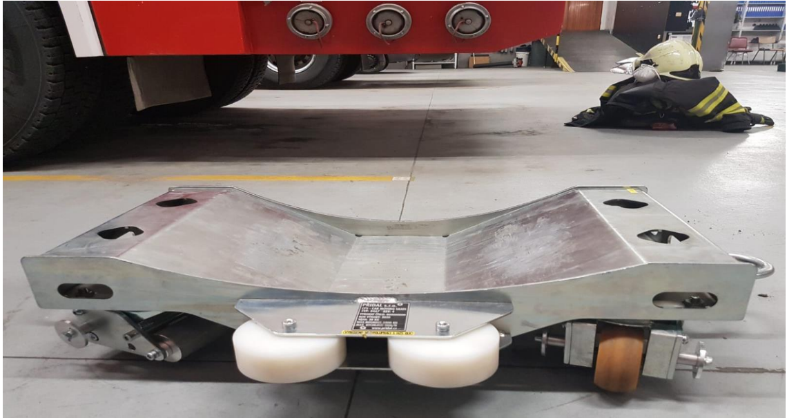
Obrázek č. 14 Manipulační vozík pro transport elektromobilu. 73
