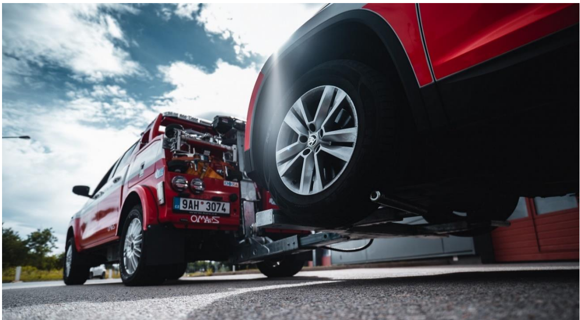
Obrázek č. 17 Vyprošťovací automobil Toyota Hilux s odtahovými brýlemi Omars. 77
