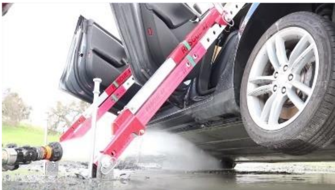
Obrázek č. 12 Ochlazování baterie elektromobilu stabilizovaného na boku. 68
