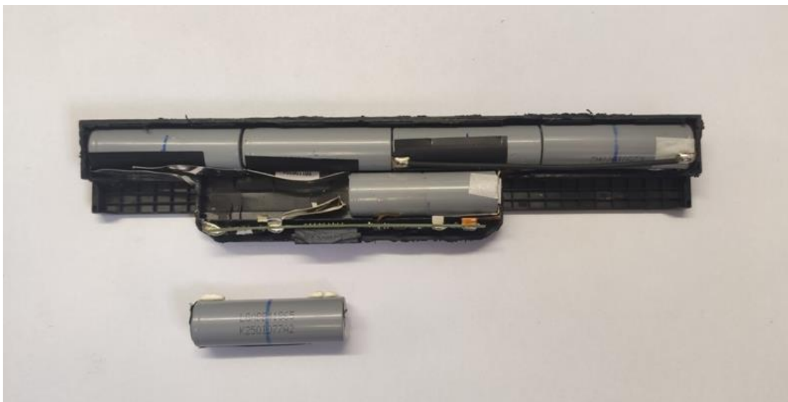
Obrázek č. 2 Modul s články, článek baterie – zapojení sériově paralelní. 5
