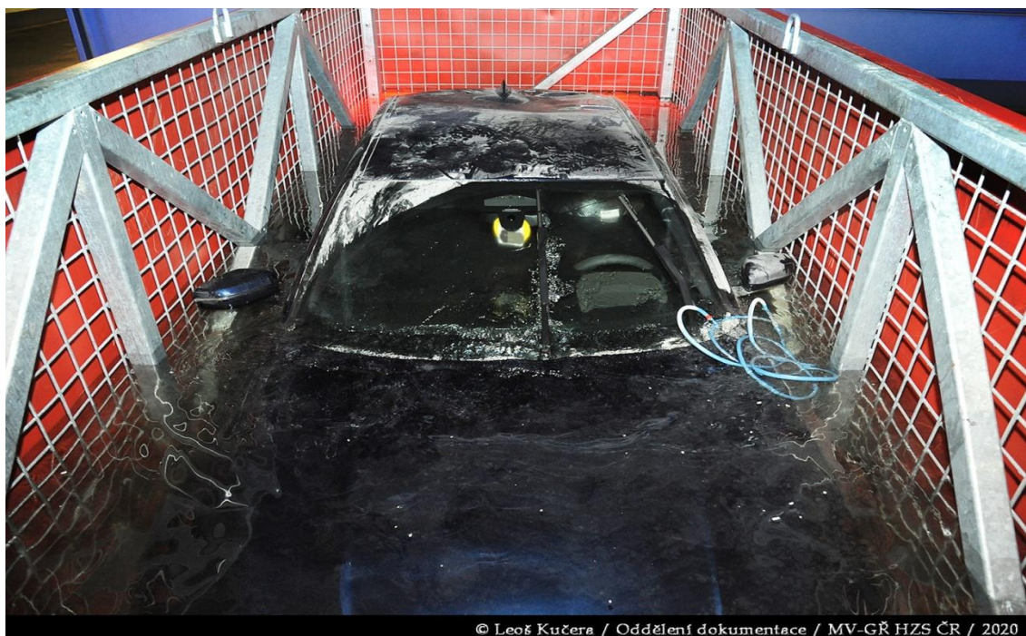
Obrázek č. 13 Ponoření elektromobilu do kontejneru s vodou. 69
