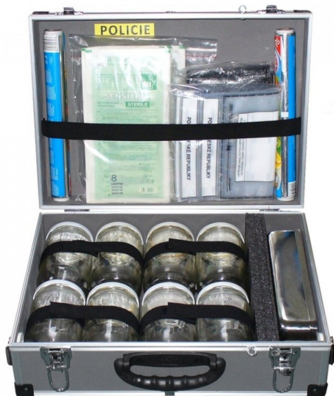
Obrázek 1 Kufř na odběr pachových stop 85
