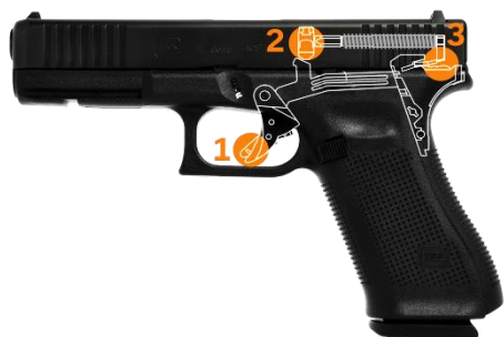
Obrázek 34 Vyobrazení pojistek systému Safe Action u pistole Glock 17 170
