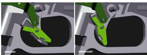
Obrázek 35 Vyobrazení mechanické pojistky spouště 171
