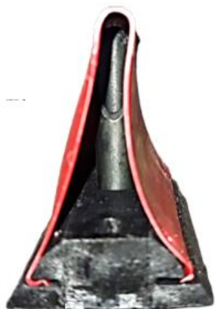
Obrázek 28 Dutý hrot pro vypuštění vzduchu z pneumatik vozidla 160
