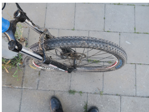
Obr. 5: Pohled na poškození předního kola 44 .
