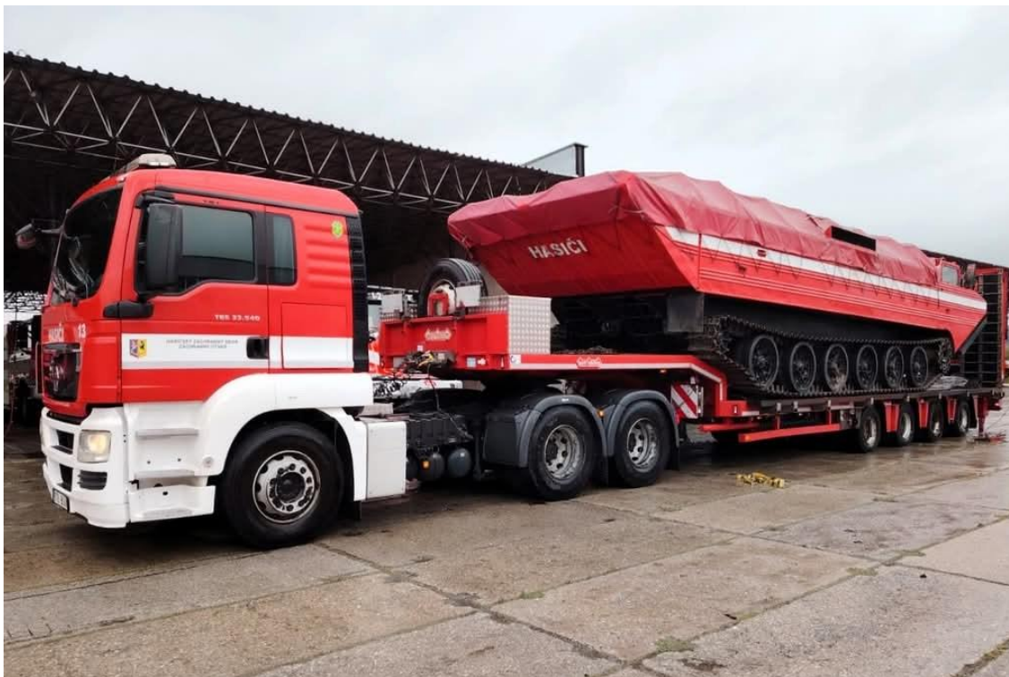
Obr. 22: Souprava MAN TGS 33.540 s podvalem Noteboom a naloženým PTS-10 52
