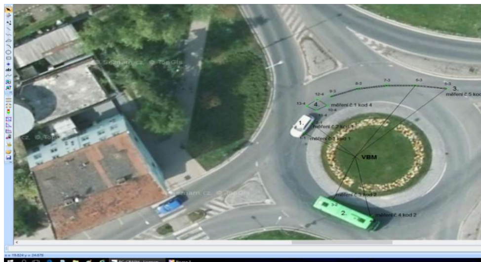
Obr. 22 Zaměření místa DN totální stanicí 69
