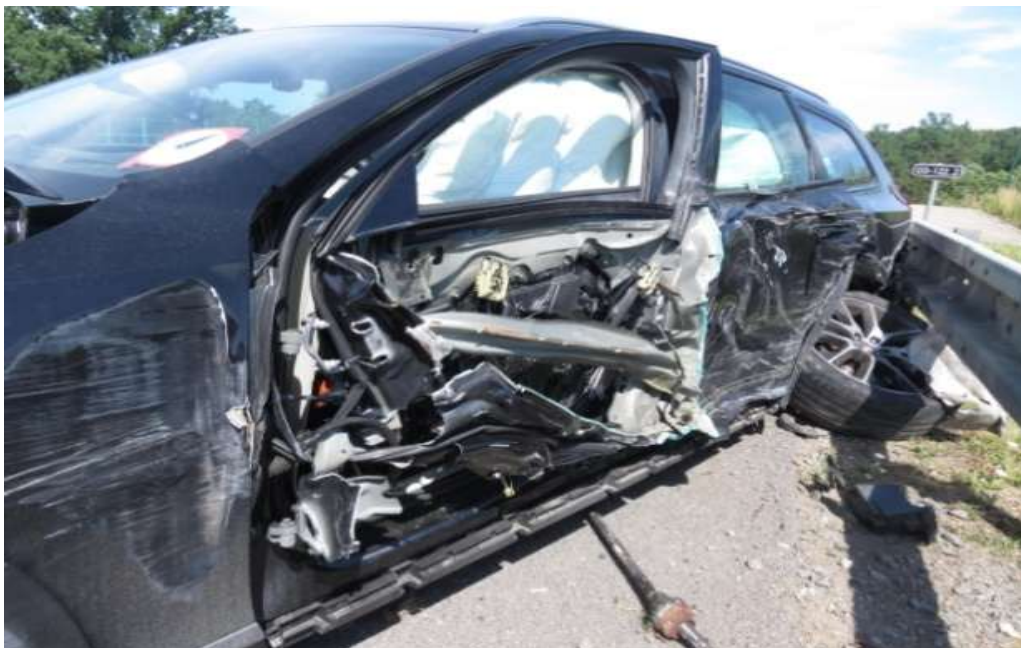
Obr. 11 Boční náraz vozidla do svodidla 44
