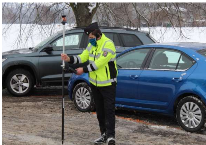
Obr. 25 Výtyčka robotické totální stanice 72
