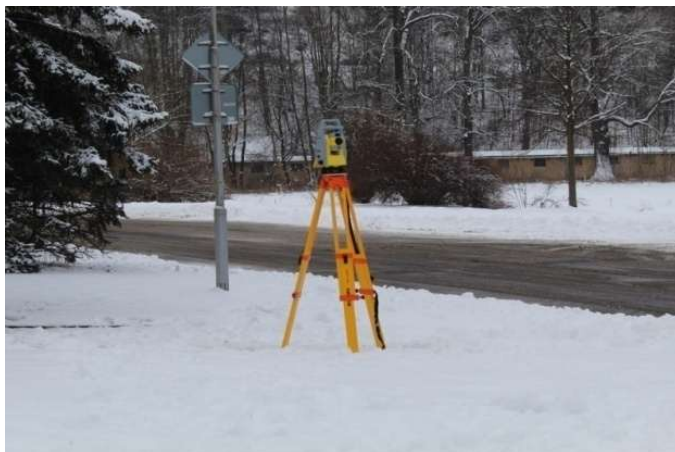
Obr. 25 Výtyčka robotické totální stanice 72
