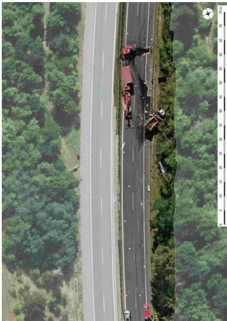
Obrázek č. 4 - Podklad pro plánec místa dopravní nehody, vytvořený vícesnímkovou fotogrammetrií 80
