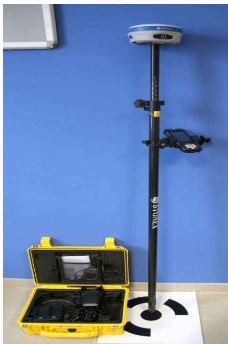
Obrázek č. 3 – RTK GNSS stanice Stonex S900 a vřícovací bod 76
